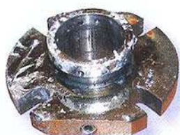
defektna klizna prstenasta zaptivka
